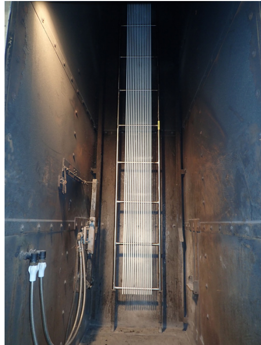
Bild 1: Messung der Wärmefreisetzung und Raucherzeugung von Kabeln nach EN 50399 – vor dem Versuch (Quelle: VDE Prüf- und Zertifizierungsinstitut GmbH)
