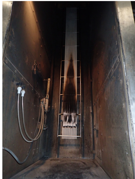
Bild 2: Messung der Wärmefreisetzung und Raucherzeugung von Kabeln nach EN 50399 – nach dem Versuch (Quelle: VDE Prüf- und Zertifizierungsinstitut GmbH)
